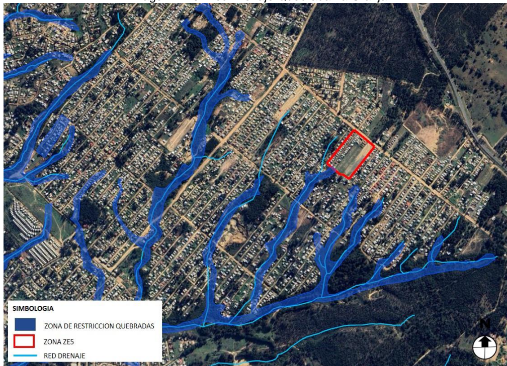
Imagen N°10: Red Drenaje Quebrada La Granja
